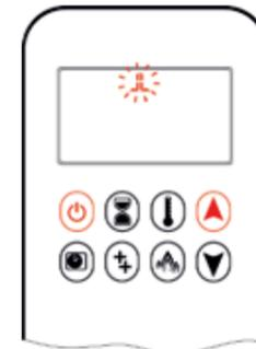
Drücken Sie die Taste (Zündung mit einer Taste) oder Tasten und gleichzeitig (Zündung mit zwei Tasten), bis zwei kurze akustische Signale und eine Reihe blinkender Linien bestätigen, dass die Startsequenz begonnen hat. Lassen Sie die Taste(n) los.
